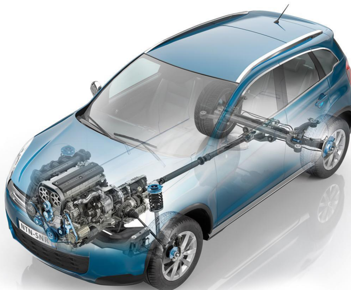
Obr. 1 Model motoru a náprav automobilu
