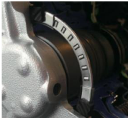
Obr. 5 Ihličkové ložisko v automatickej prevodovke
