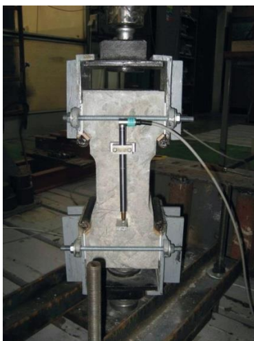
Obr. 1.3: Zkušební těleso ve tvaru dogbone pro zkoušku v prostém tahu [11]
