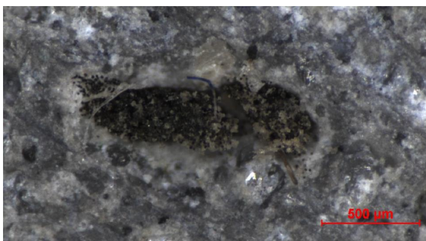
Obr. 2.8: Snímek rovingu v betonu z obrazové analýzy
