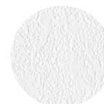
šľuková vápenná omietka povrch stien v interiéri
