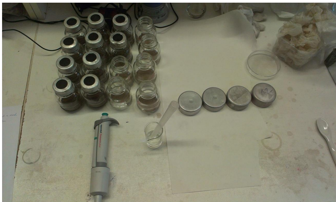
Obr. 14 Provádění substrátem indukované respirace (aplikace roztoku glukózy)
