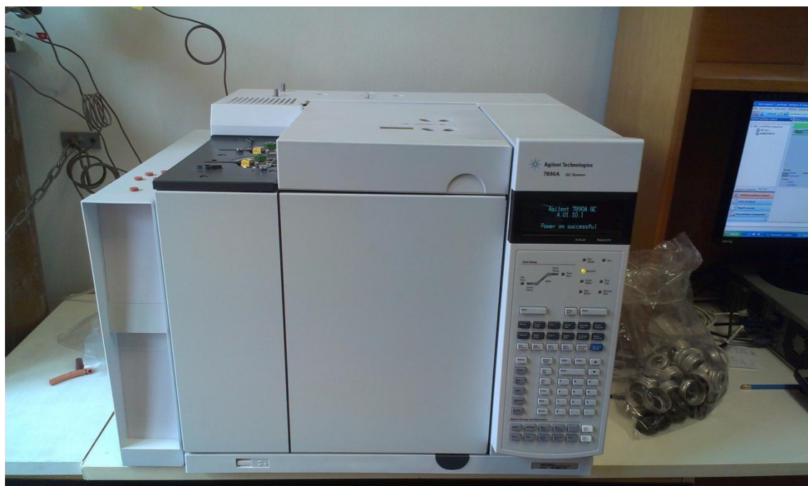
Obr. 16 Plynový chromatogram při analýze odebraného plynu
