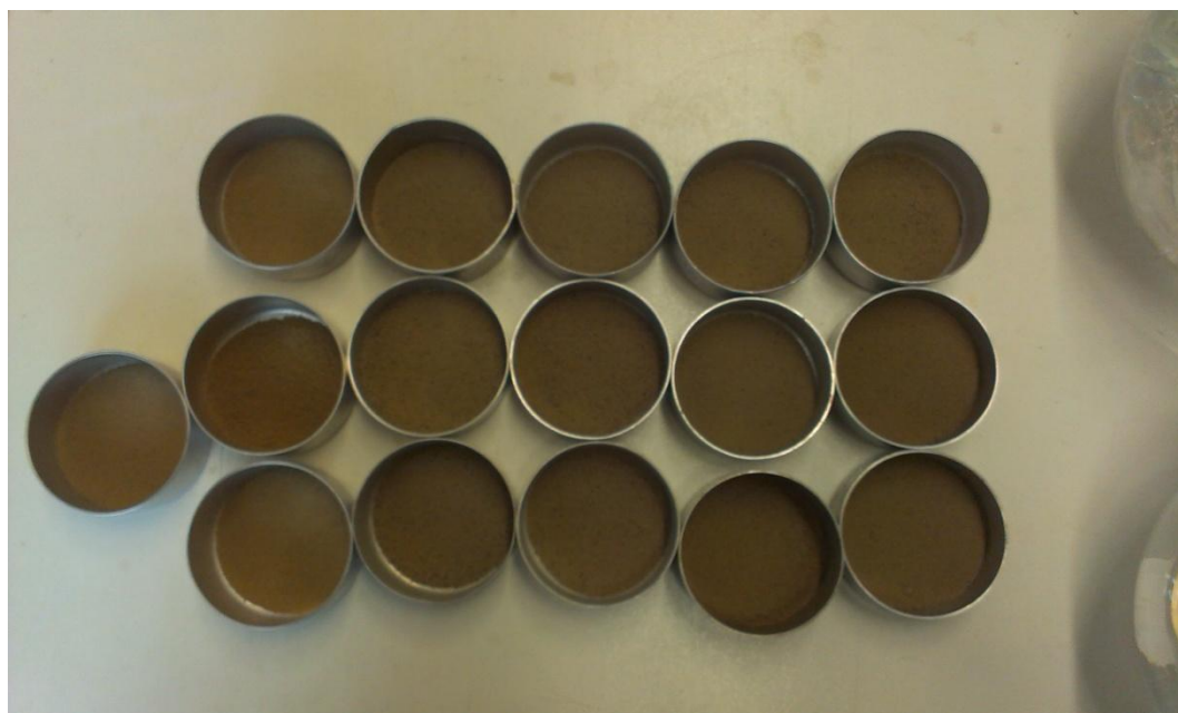
Obr. 15 Vzorky půdy připravené ke stanovení sušiny
