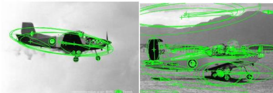
Příklad klíčových bodů získaných pomocí MSER detektoru (popis pomocí SURF deskriptoru)
