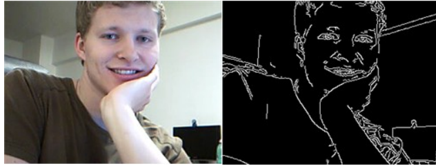
Obrázek 1 Ilustrace detekce příznaků v obličeji pomocí Cannyho hranového detektoru.
