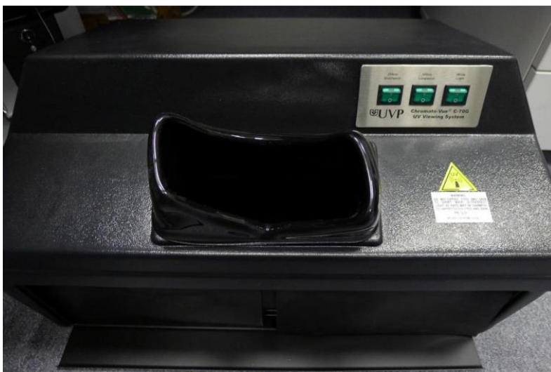
Obr. 15: UV box se zářením o dvou vlnových délkách a s osvětlením. Krátká vlnová délka 254 nm, dlouhá vlnová délka 366 nm. Je určen pro přímé vkládání lišejníků pro UV reakci i pro vyhodnocení chromatografické desky. (Foto J. Kocourková, 2021)
