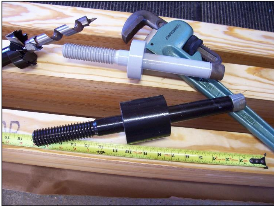
Obr. 14 Speciální šroubovací kotva a potřebné nářadí na její umístění (Carberry J., 2016)
