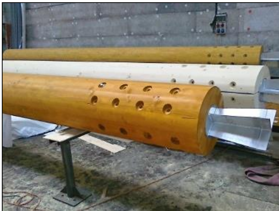
Obr. 30 Ukázka reálného ocelového prvku pro nosný sloup (Lekon-TSK s.r.o., 2016)
