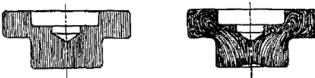
Obr. 3.7 Průběh vláken v obráběné a tvářené součásti [1]
