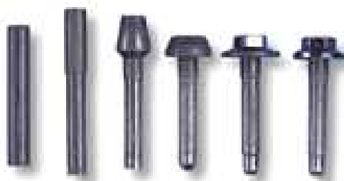
Obr. 3.8 Technologický postup výroby šroubu tvářením za studena [12]
