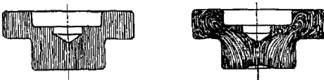
Obr. 3.7 Průběh vláken v obráběné a tvářené součásti [1]
