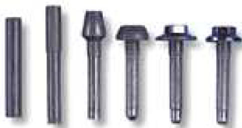
Obr. 3.8 Technologický postup výroby šroubu tvářením za studena [12]
