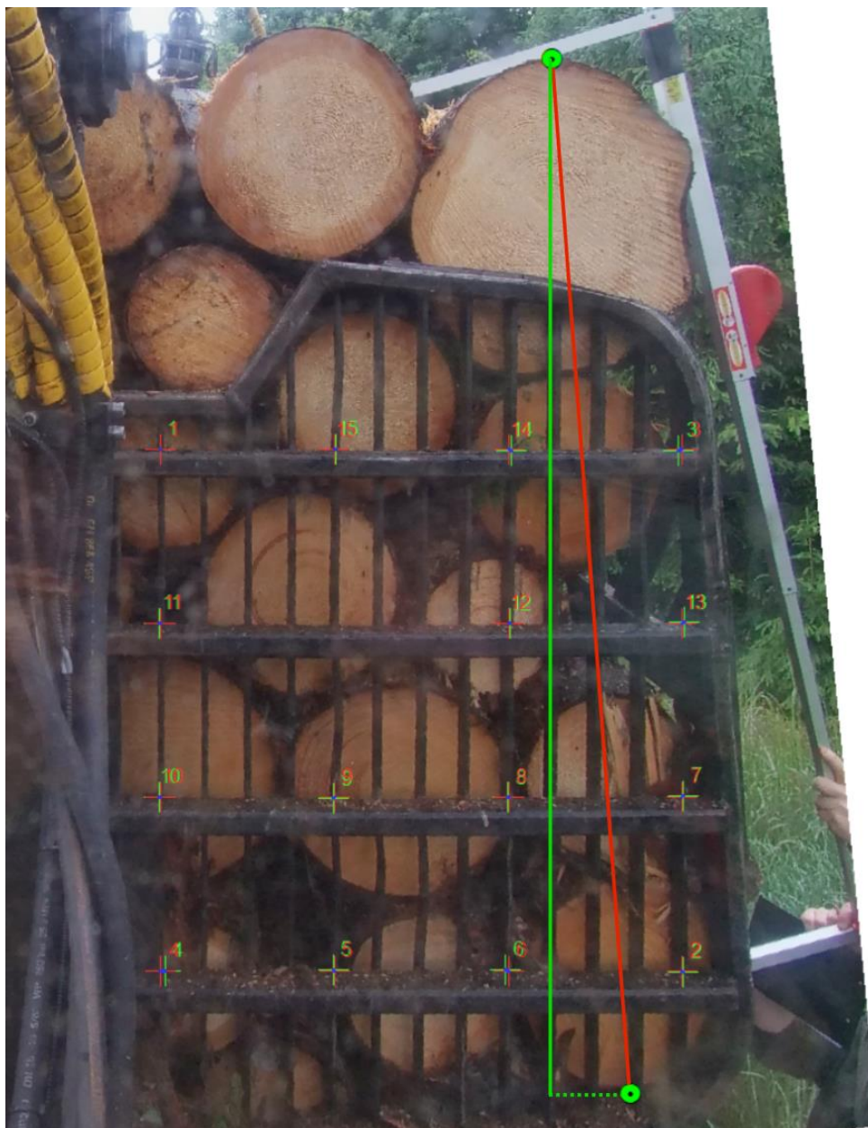
Obrázek č. 16: Rektifikační mřížka s vyznačenými referenčními body a stejnými body v rámci reprojekce. Červená čára ukazuje šikmou vzdálenost mezi body měření výšky a čára zelená vertikální výšku
