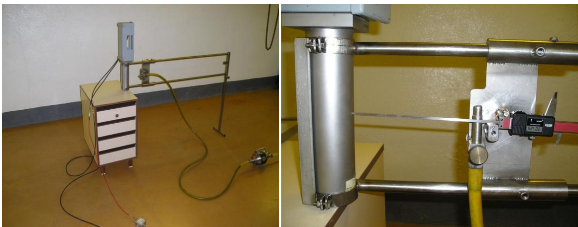
Obr. 14 Přípravek substituční metody a ukázka odměřování vzdálenosti (detektor na obrázku je v přípravku otočen o 180°)
