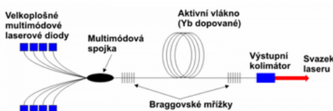
Obrázek 2.11: Princip vláknového laseru [12]
