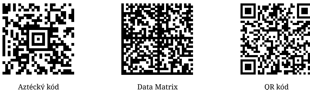
Obrázek 2.2: Dvourozměrné datové kódy. Vygenerovány pomocí [10]. Všechny obsahují stejný řetězec názvu práce bez interpunkce. Zleva: Aztécký kód, Data Matrix, QR kód.
