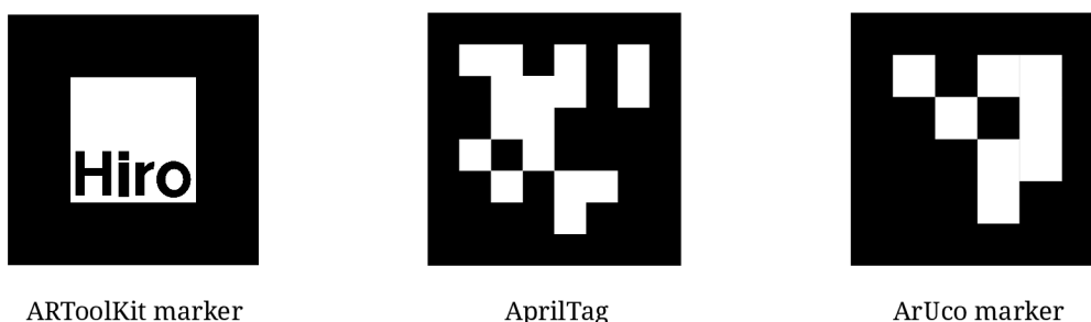
Obrázek 2.1: Referenční značky. Zleva: ARToolKit marker [2], Apriltag [3], ArUco marker [4]
