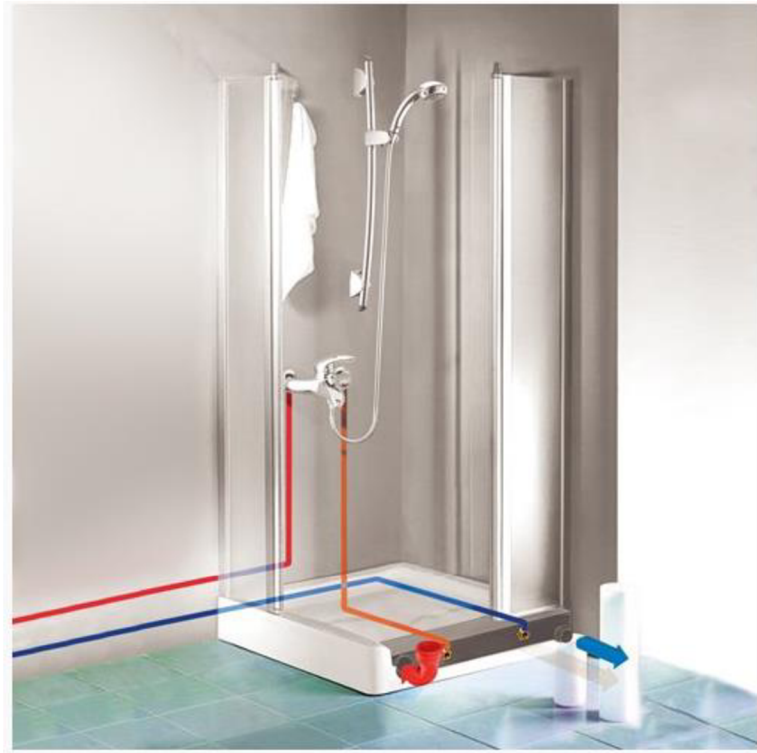
Obrázek 21 NELA výměník (modře čistá studená voda, oranžově výstup čisté přehřáté vody) [65]
