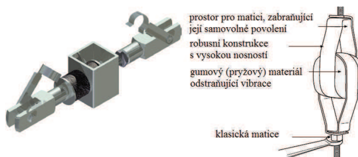
Obr. 23 Příklady antivibračních závěsů, upraveno z [35] [36]
