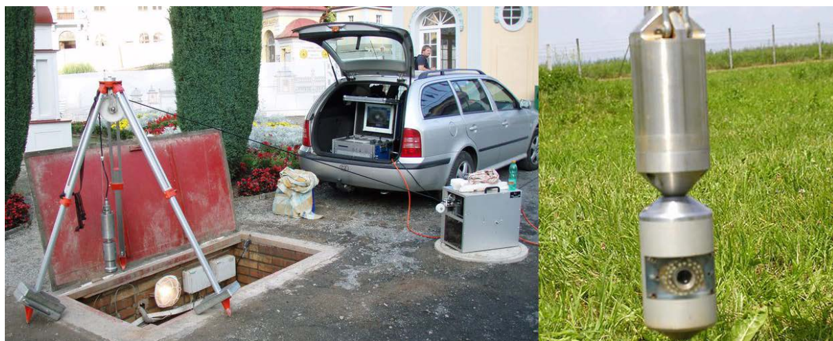
Obrázek 3.2 Zařízení ke kamerovému průzkumu vrtů a studní [18]
