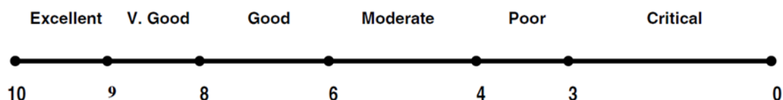
Obrázek 3.1 Grafické znázornění měřítka technického stavu podle Al-Barqawi a Zayed, zdroj [4]
