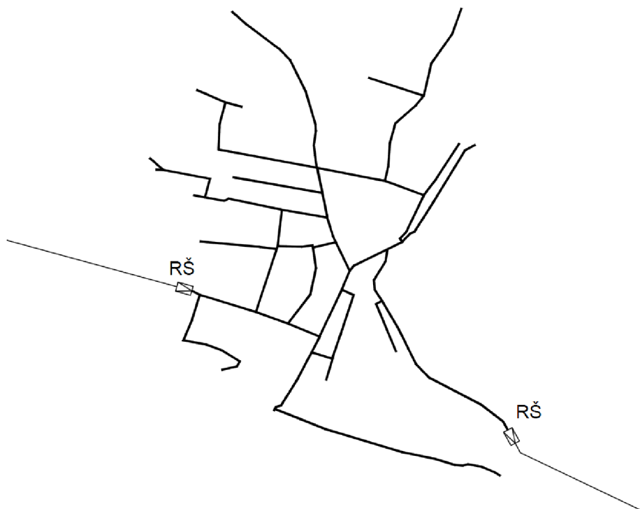
Obrázek 5.12 Schéma hodnocené vodovodní sítě TP3-L10.1
