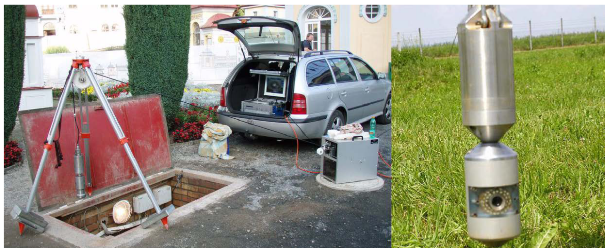
Obrázek 3.2 Zařízení ke kamerovému průzkumu vrtů a studní [18]
