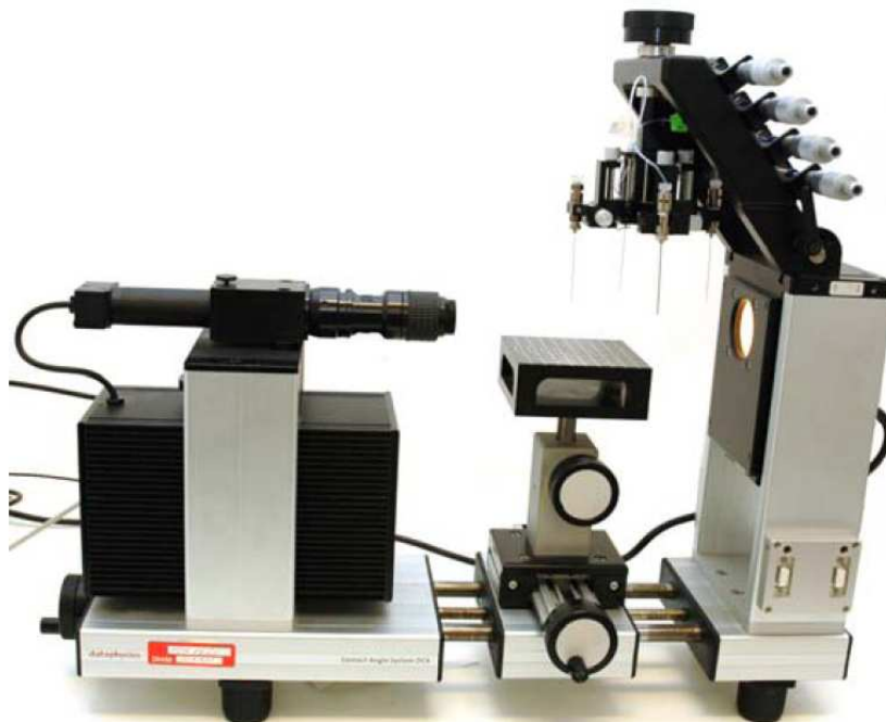
Obrázek 27: Přístroj Contact Angle System OCA pro měření kontaktního úhlu
