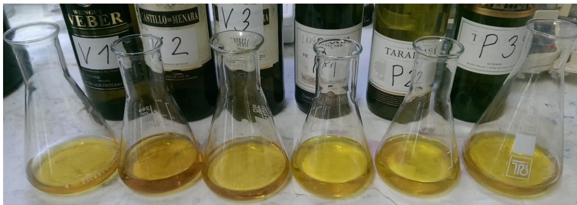
Obr. 15 Proces uvoľňovania oxidu siričitého z väzieb s karbonylovými zlúčeninami v alkalickom prostredí po pridaní roztoku NaOH do vína.
