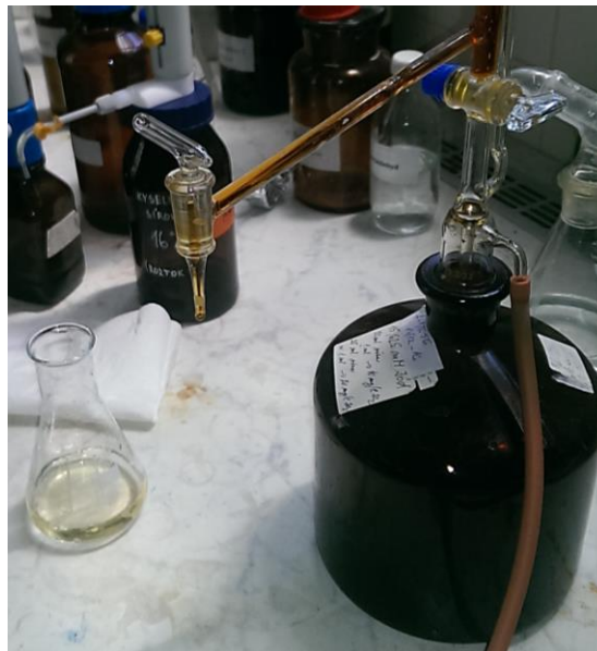
Obr. 14 Titrácia roztokom jódu pri meraní voľného oxidu siričitého vo vzorke vína.
