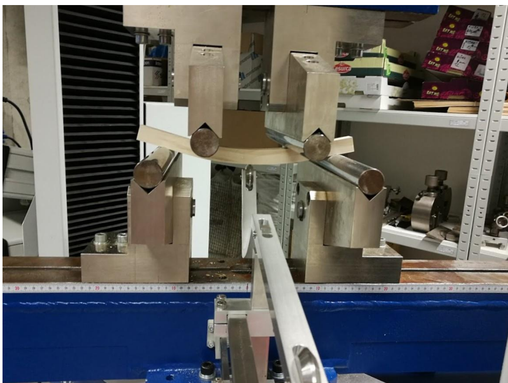
Obrázek 27 Zkouška statické pevnosti
