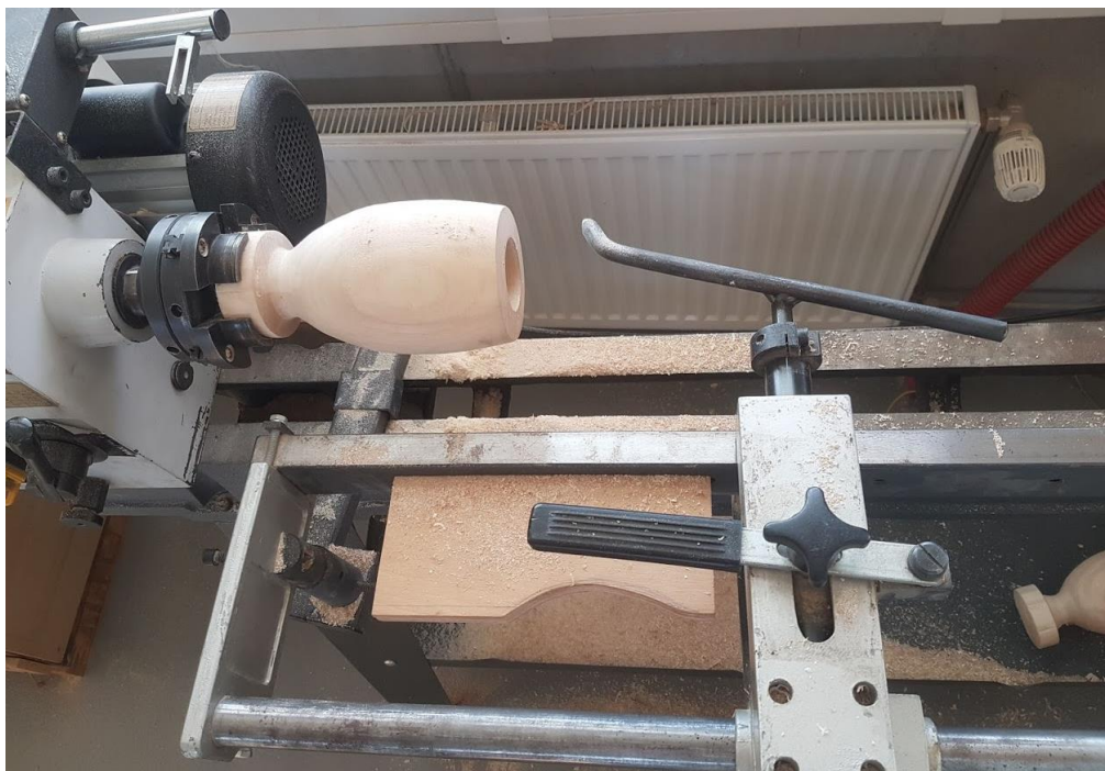
Obrázek 21 Soustružení kopírovacím zařízením
