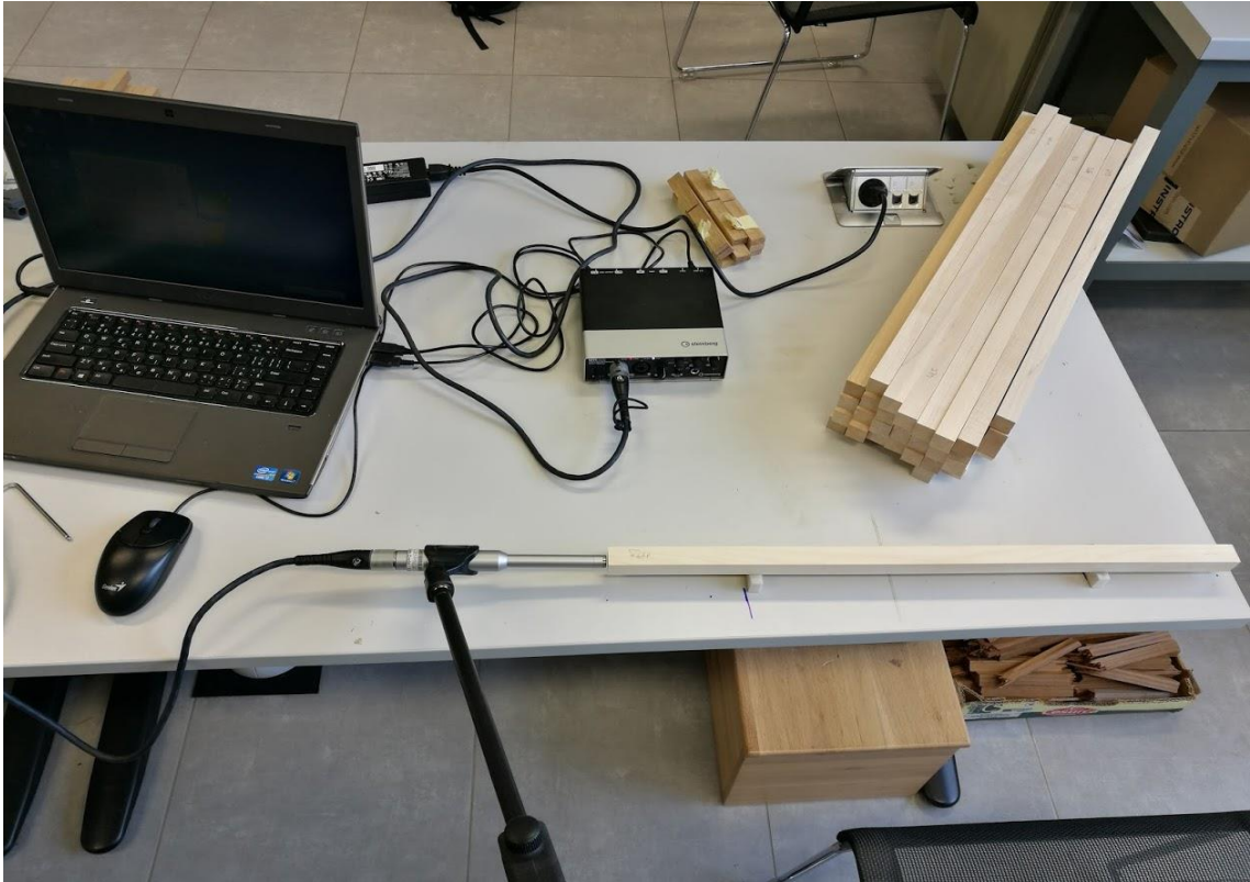
Obrázek 25 Snímací aparát rezonanční metody
