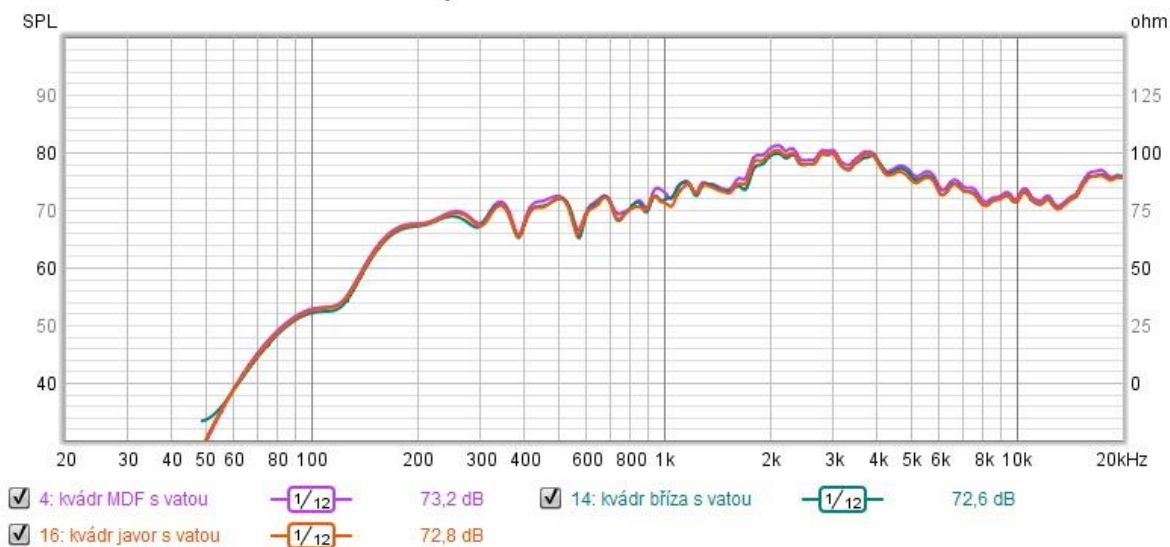
Graf 13 Ozvučnice tvaru kvádrů – porovnání dřevin s použitím vnitřního tlumicího materiálu
