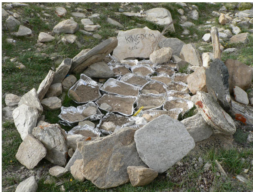
Obr. 12 – Sušení vzorků půdy na hliníkových deskách (foto: K. Čapková).
