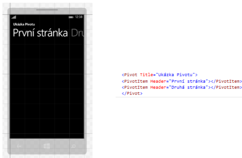
Obrázek č. 9: Ukázka šablony Pivot v emulátoru a v deklaraci v jazyce XAML
