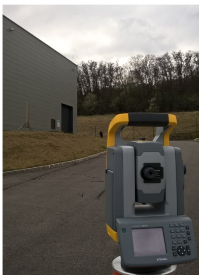
Obr. 15 Zaměrování kontrolních profilů
