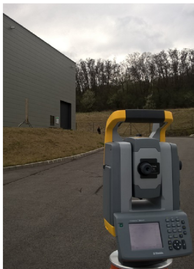
Obr. 15 Zaměrování kontrolních profilů
