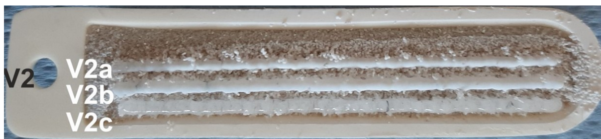
Obr. 6 Experiment realizovaný s křemičitými písky, CO 2 laser s maximálním výkonem 40 W. Vzorek V2, experiment byl realizovaný s různou rychlostí a výkonem.
