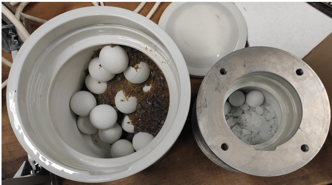
Obr. 20 Porcelánový mlýn kulový 6 l (vlevo) a 1,3 l (vpravo) s porcelánovými mlecími koulemi různých průměrů a skelnou drtí.
