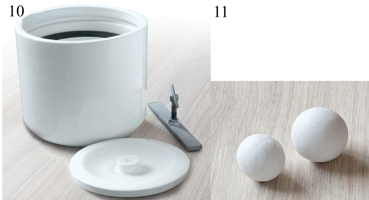
Obr. 10 Porcelánový mlýn kulový s víkem, uzávěrem a těsněním [34]
