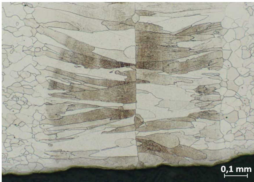
Obr. 43 Mikrostruktura kořenové vrstvy svarového kovu svařené laserem
