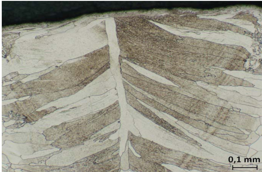
Obr. 42 Mikrostruktura povrchové vrstvy svarového kovu svařené laserem
