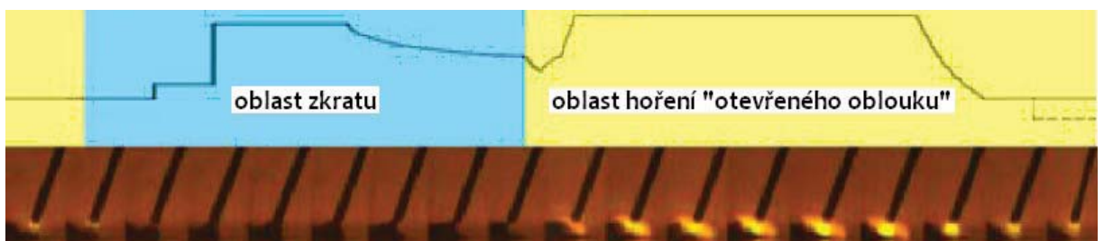
Obr. 19 Proudová vlna procesu Fast Root v okamžiku přenosu kapky kovu do svarové lázně [13]
