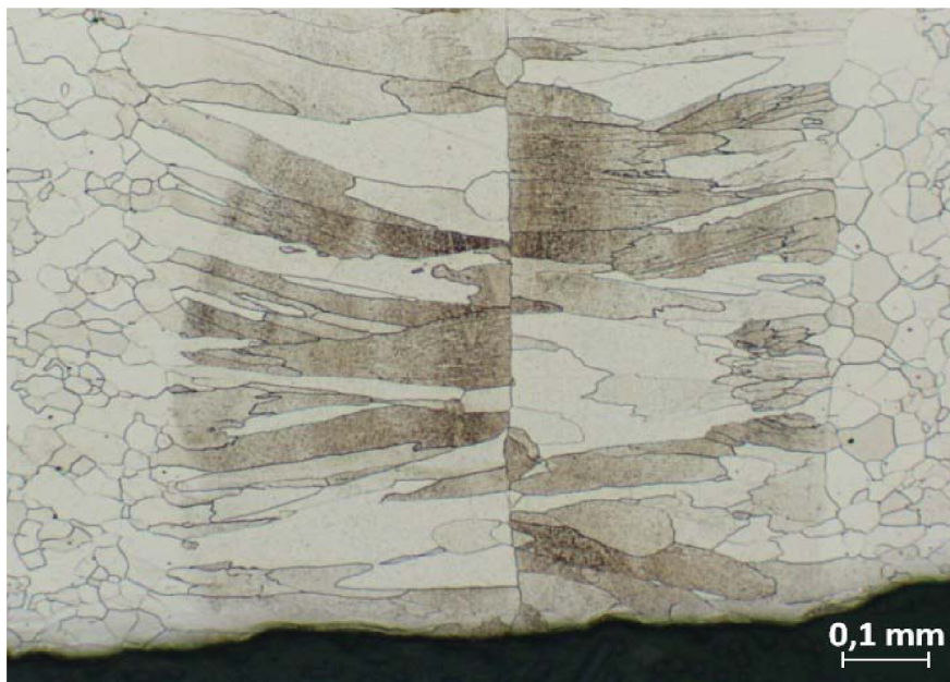
Obr. 43 Mikrostruktura kořenové vrstvy svarového kovu svařené laserem
