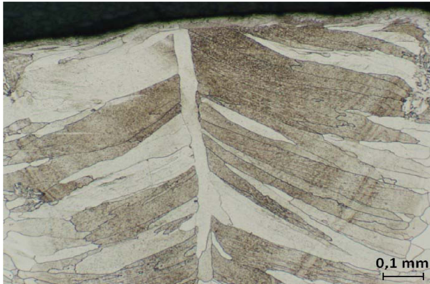
Obr. 42 Mikrostruktura povrchové vrstvy svarového kovu svařené laserem
