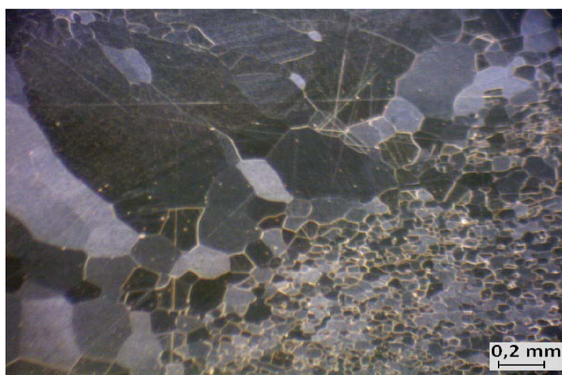
Obr. 32 Přechod svarového kovu přes TOO do základního materiálu
