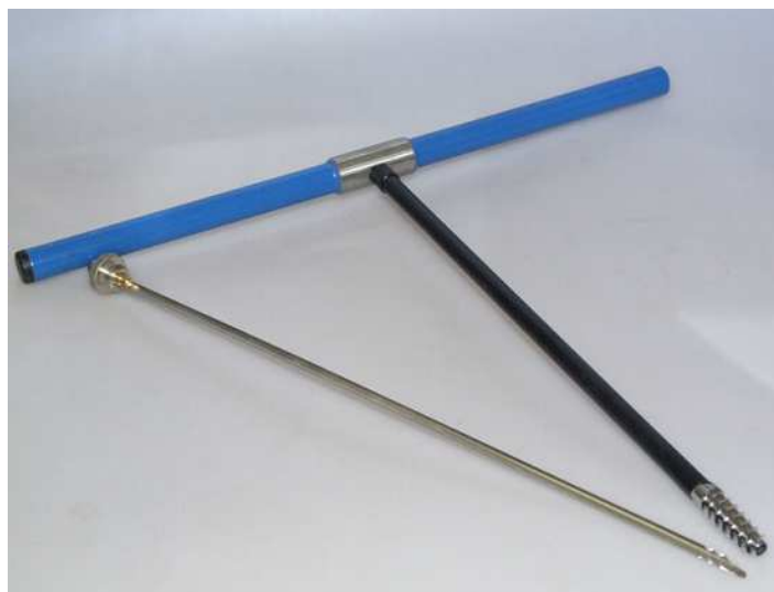
Obrázek 6: Presslerův přírůstkový nebozez ( www.dendrochronologie.cz )
