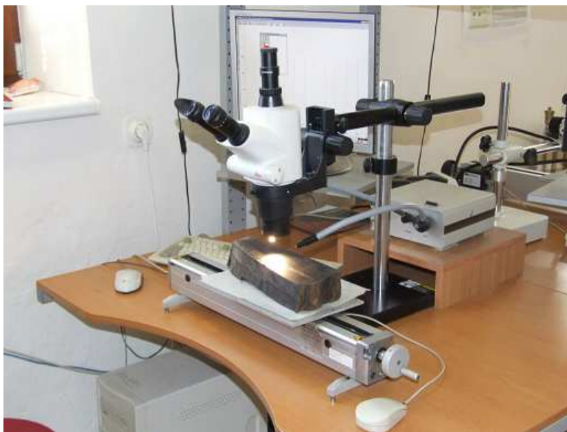
Obrázek 11: Měřicí stůl ( www.dendrochronologie.cz )
