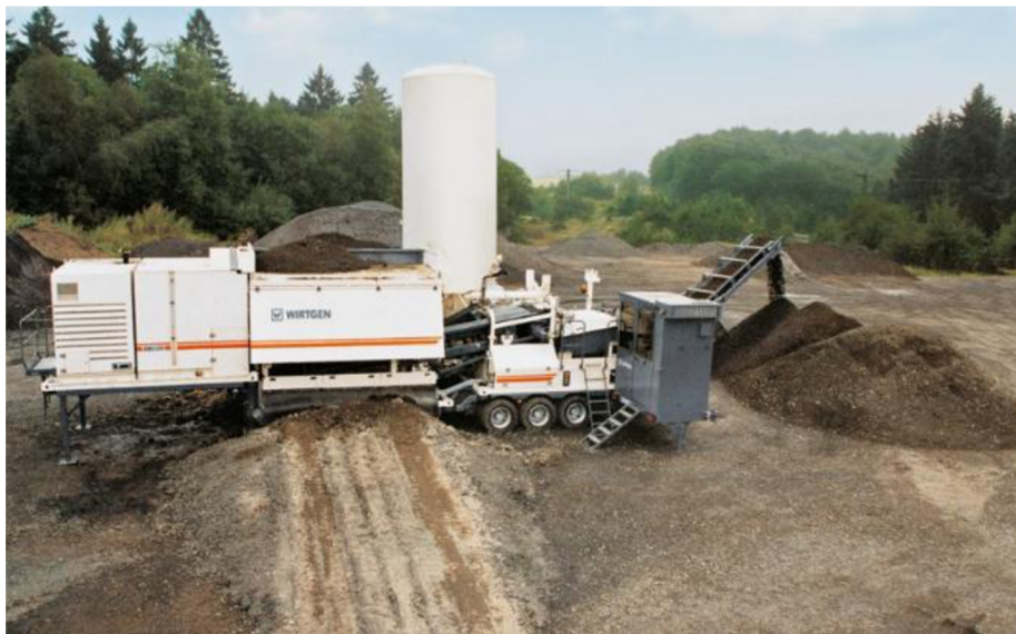
Obr. 3.5 Recyklace v míchacím centru za studena [8]
