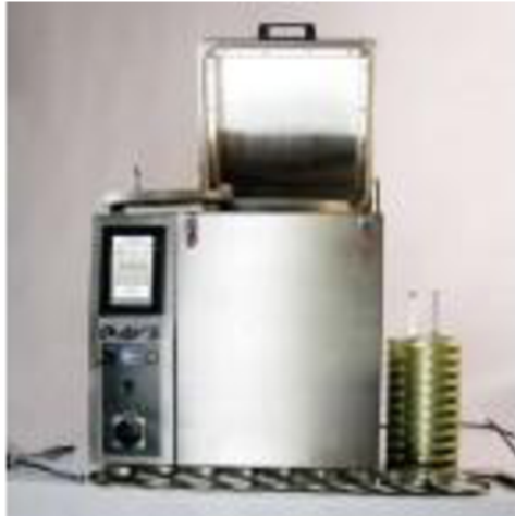
Obr. 3.20 Zkušební zařízení pro metodu PAV [20]
