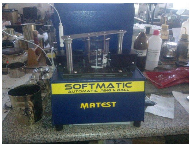
Obr. 4.5 Zkušební zařízení pro metodu Kroužek a kulička [25]
