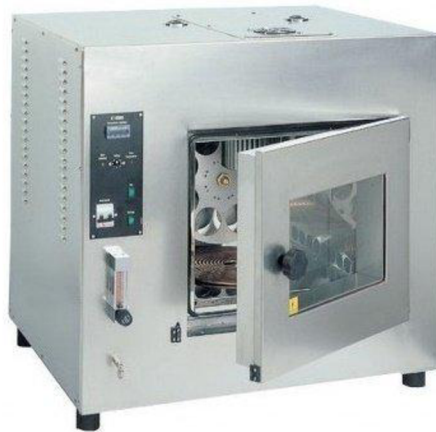
Obr. 3.19 Zkušební zařízení pro metodu RTFOT [19]
