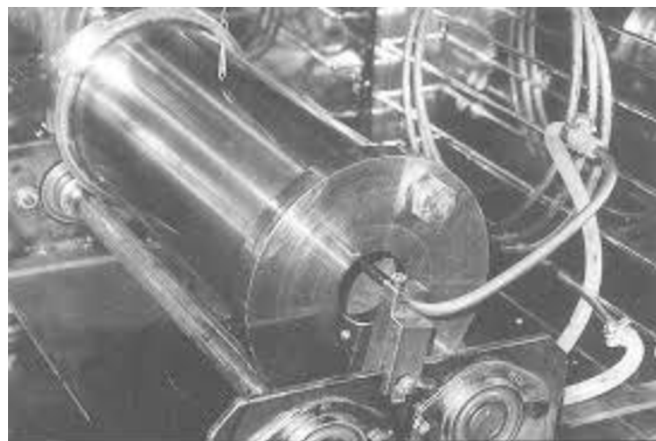
Obr. 3.21 Zkušební zařízení pro metodu RCAT [21]
