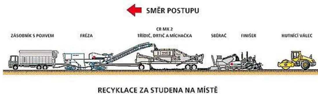
Obr. 3.6 Schéma recyklace na místě za studena [10]
