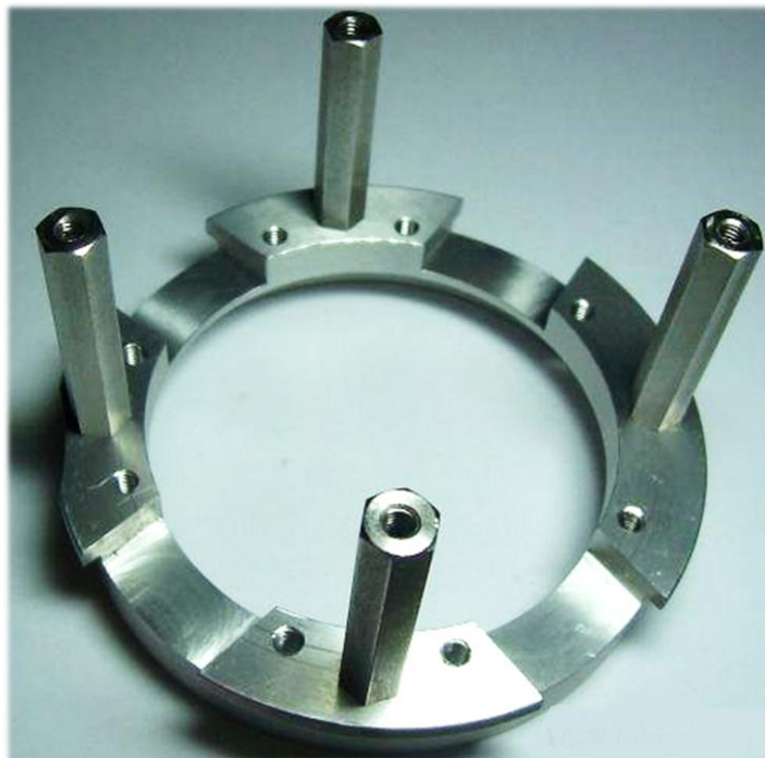
Obr. 10 Upravené zapalování se třemi původními pozicemi [10].
