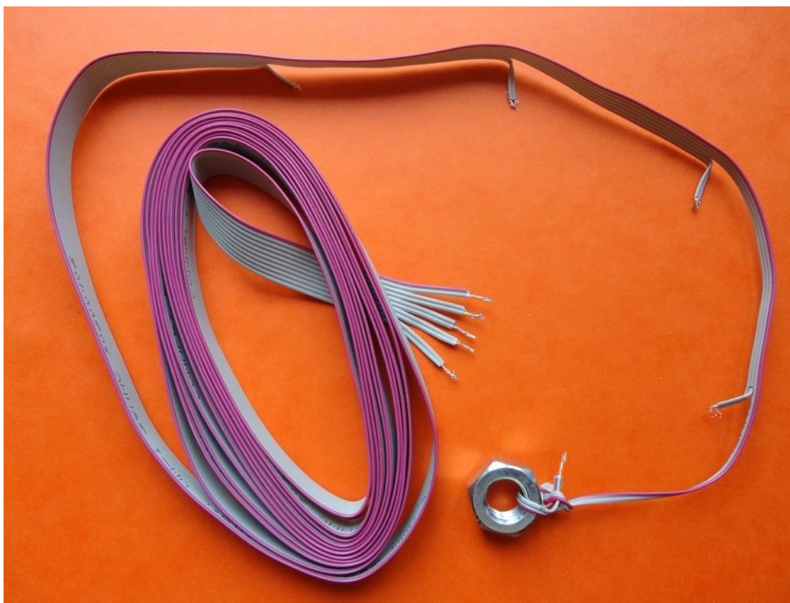
Obrázek 2.13 Mechanické konstrukce sondy hladinoměru [3]
