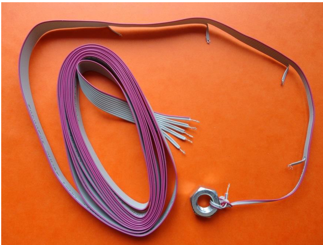
Obrázek 2.13 Mechanické konstrukce sondy hladinoměru [3]
