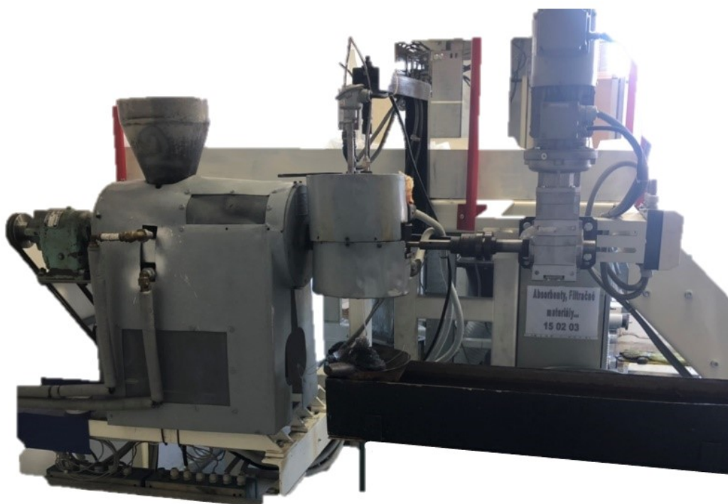
Obr. 3.8 Experimentálna linka s extrúderom.
