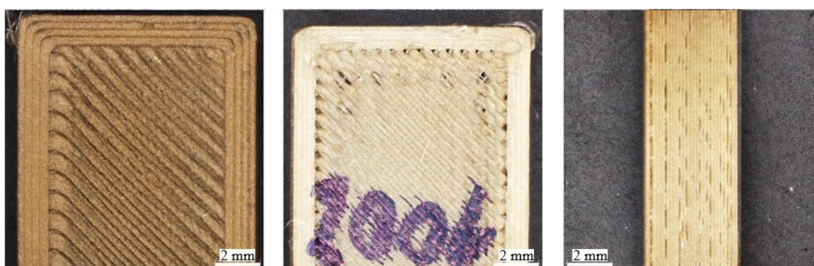
Obr. 4.31 Vrchná plocha (vľavo), spodná plocha (stred), bočná plocha (vpravo) pri zväčšení 25krát.
