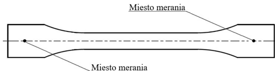
Obr. 4.13 Vyznačené miesta vtláčenia indentoru do vzorky.
