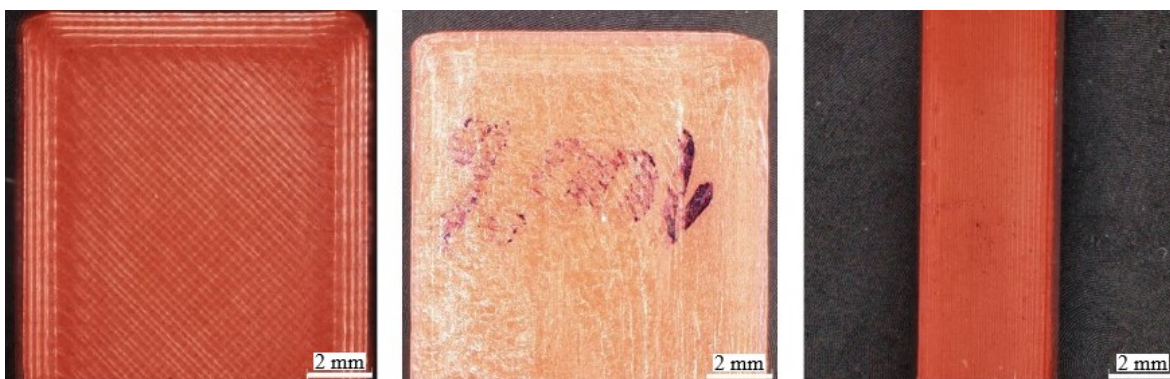
Obr. 4.21 Vrchná plocha (vľavo), spodná plocha (stred), bočná plocha (vpravo) pri zväčšení 25krát.
