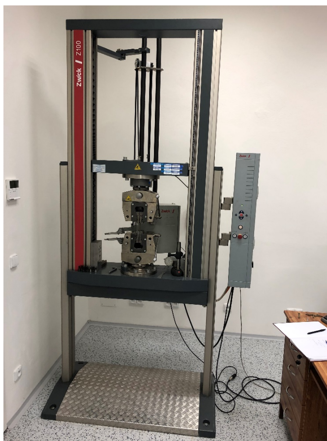
Obr. 4.4 Skúšobné zariadenie Zwick Z100.
