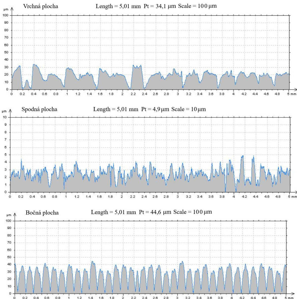
Obr. 4.24 Profily drsnosti povrchu vzorky s červeným aditívom.
