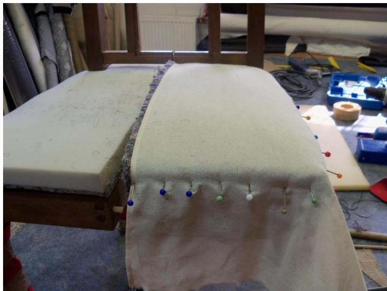
Překrytí žíní vatou a přepnutí klinem
