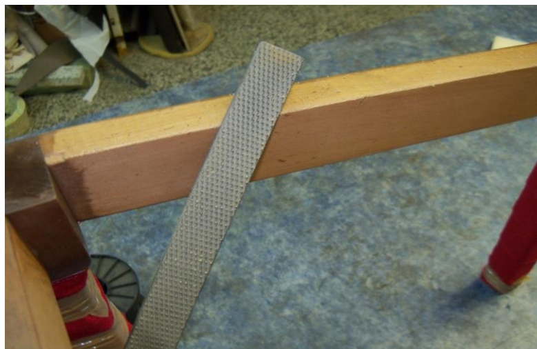
Obr. 15 broušení hran dřevěné kostry
