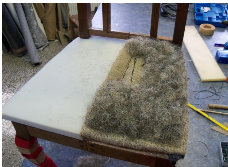
Vrstvení kypřící vrstvy
