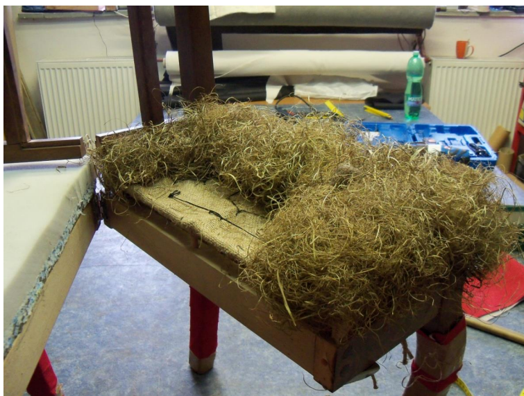
Vrstvení plnicího materiálu
