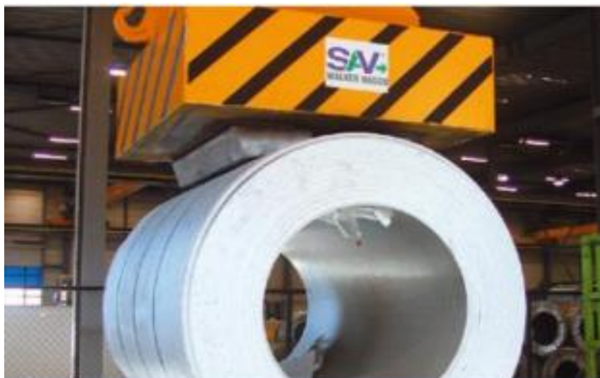
Obr. 8) Horizontální uchopení cívky pásoviny [4]
