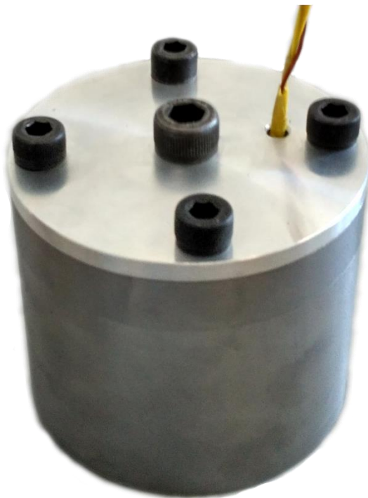
Obr. 38) Finální podoba elektro-permanentního magnetu
