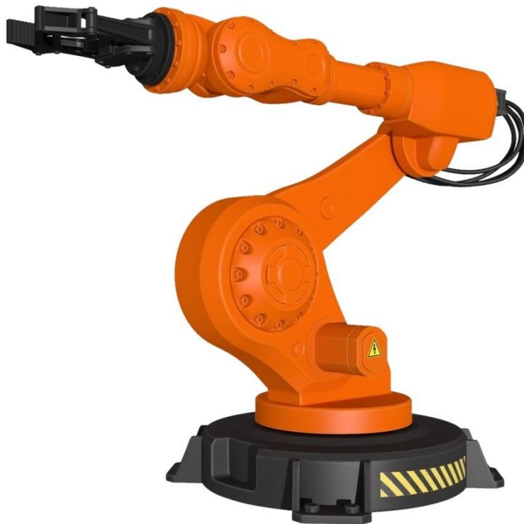
Obr. 10) Kinematický řetězec s koncovým efektořem [9]
