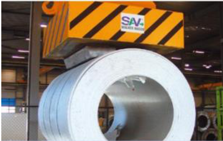
Obr. 8) Horizontální uchopení cívky pásoviny [4]
