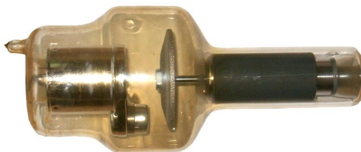
Obr. 2-18 Rentgenka s rotační anodou [26]
