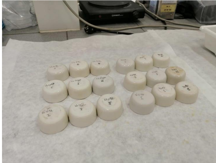
Obrázek 9 Keramické mističky připravené na analýzu TOC
