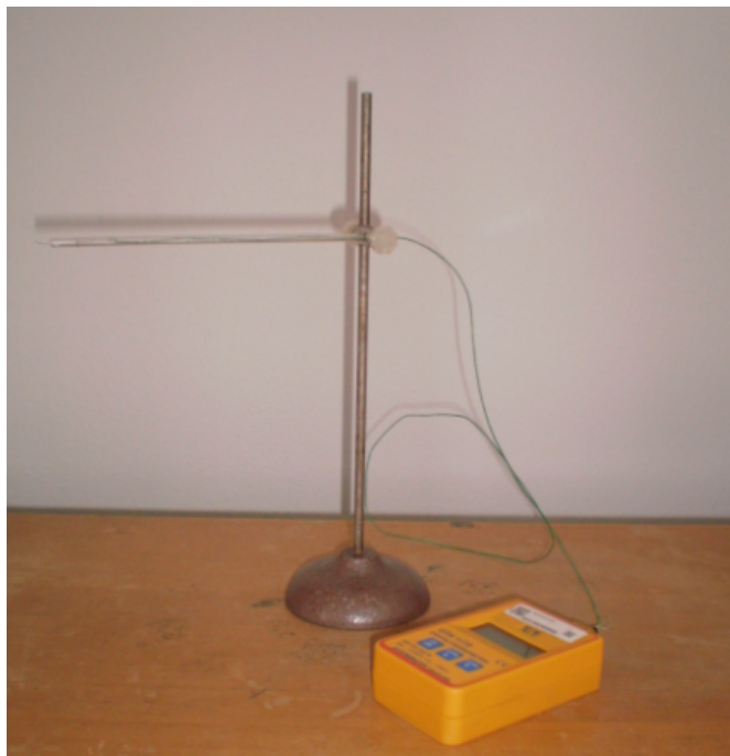
Obrázek 3.3: Termočlánek k měření teploty proudu vzduchu
