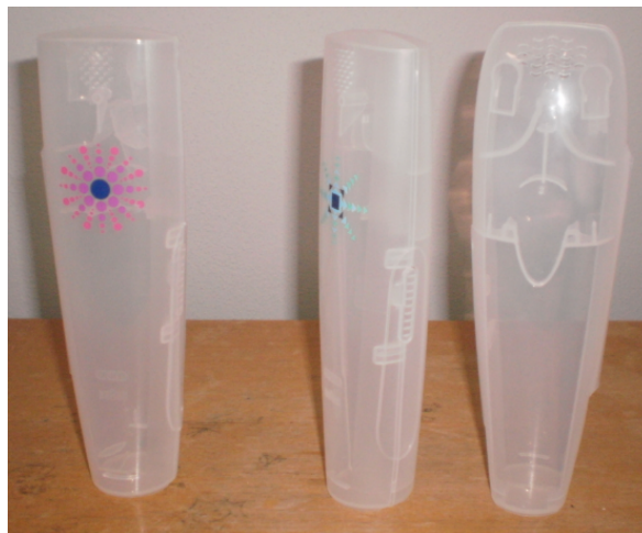
Obrázek 2.14: Polypropylen upravený plazmatem (vpravo před úpravou)
