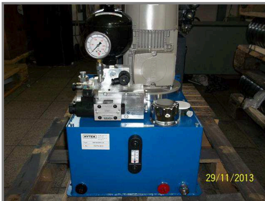
obr. 1-6 stávající hydraulický agregát
