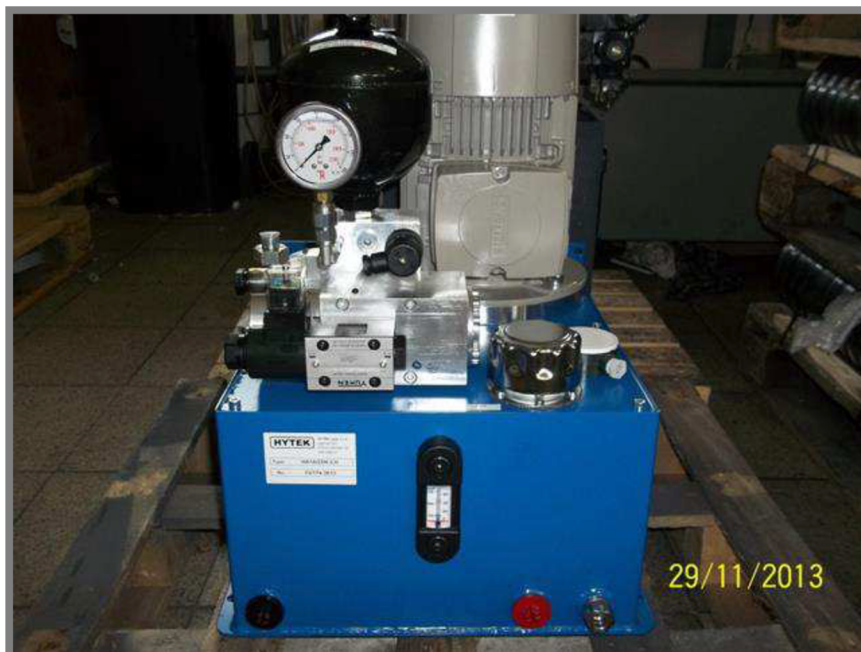
obr. 1-6 stávající hydraulický agregát
