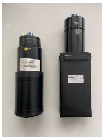
Obrázek 25 Vypůjčené detektory z Nuvia a.s., pro laboratorní měření, vlevo válcový typ, vpravo kvádrový typ
