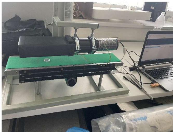
Obrázek 42 Měření konfigurace detektoru 3 (kvádrový typ)
