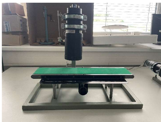
Obrázek 43 Měření konfigurace detektoru 3 (válcový typ)
