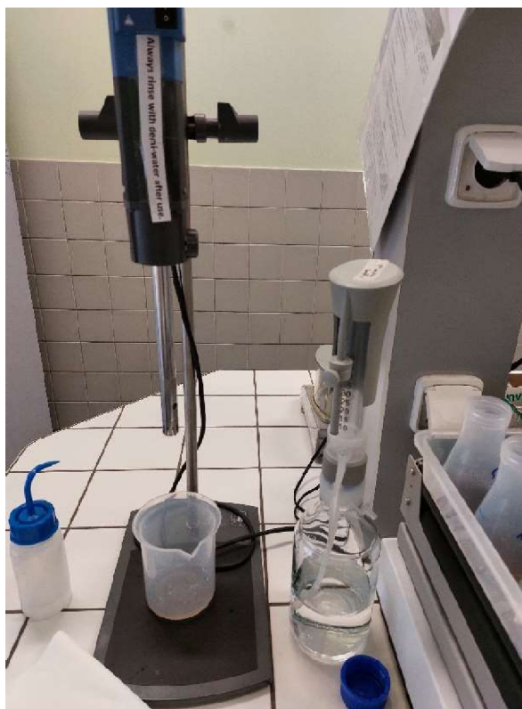
Obrázek č. 6 a 7. Erlenmeyerovy baňky s naváženými vzorky a přístroj Ultra-Turrax připravený na homogenizaci vzorků (Autor Kateřina Suchardová).
