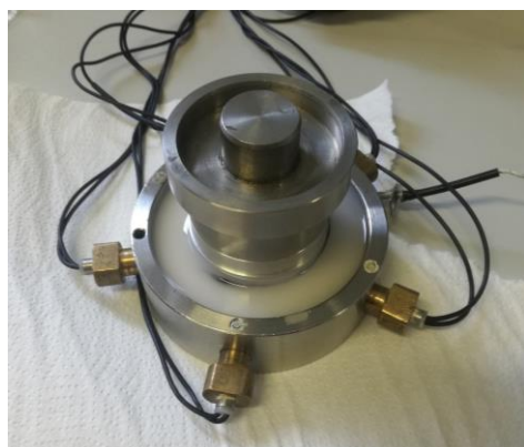
Obr. 4-5 Fotografie z průběhu zalévání umělé kloubní jamky.
