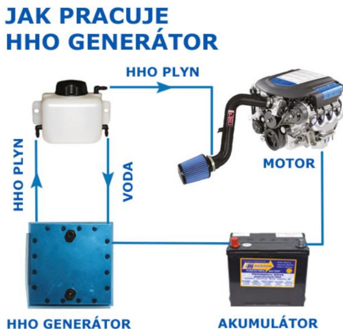
Obrázek 9: Základní schéma HHO systému [23]
