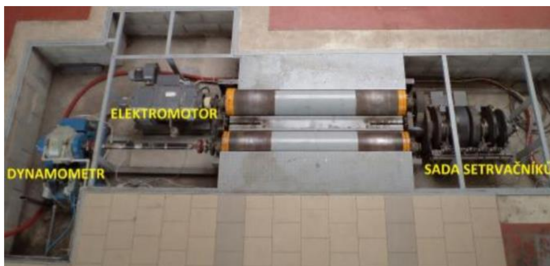
Obrázek 13: Konstrukční uspořádání válcové zkušebny [24]
