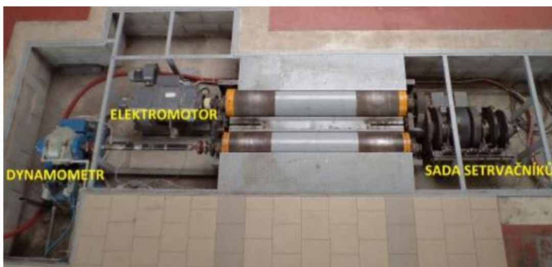
Obrázek 13: Konstrukční uspořádání válcové zkušebny [24]
