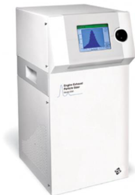
Obrázek 14: Částicový analyzátor TSI EEPS 3090 [25]
