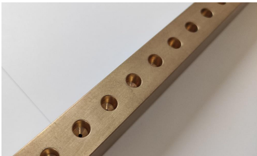
Obrátek 3.IV – Otvory pro uchycení strun na spodním nosníku
