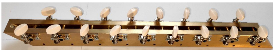
Obrátek 3.III – Instalace ladících mechanismů
